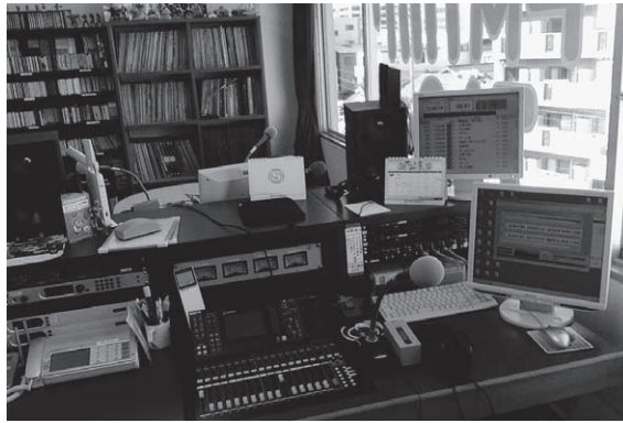
写真4 FMがいやのスタジオ。オフィスの一部を簡単なパーティションで区切っただけであり、窓も特段の防音施工などはなされていない。
