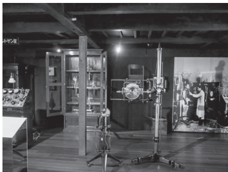
図 84 1918年開発の汎用型医療用X線装置
