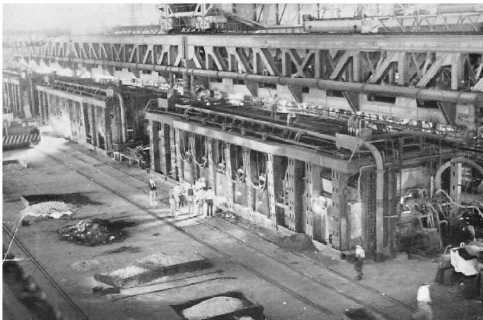
川崎製鉄・千葉製鉄所における平炉の様子。
