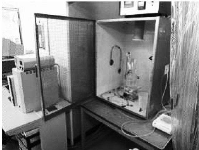
図表 13 大学と連携して開発した金属材料の腐食の度合いを測定する装置
