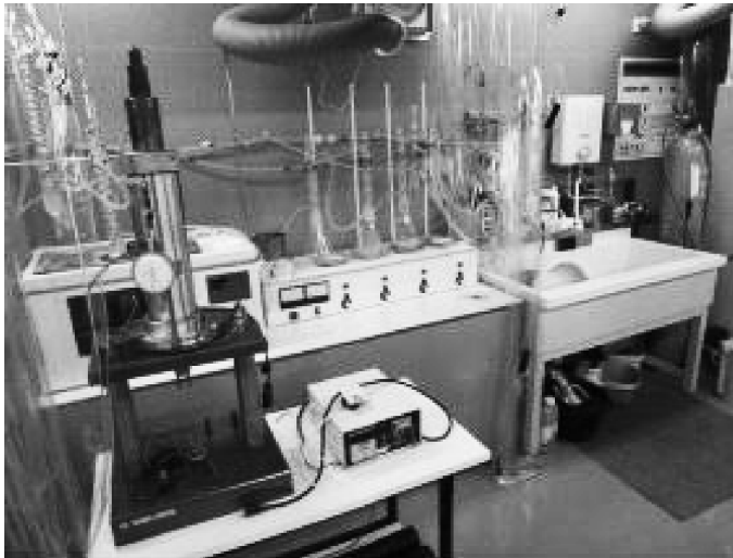
図表 13 大学と連携して開発した金属材料の腐食の度合いを測定する装置
